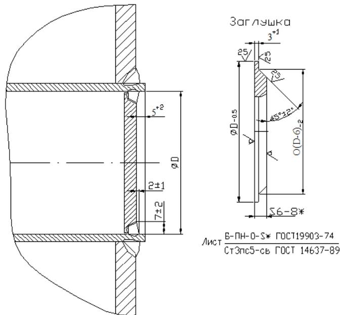
Рисунок 6 – Установка заглушки на дымогарную трубу
