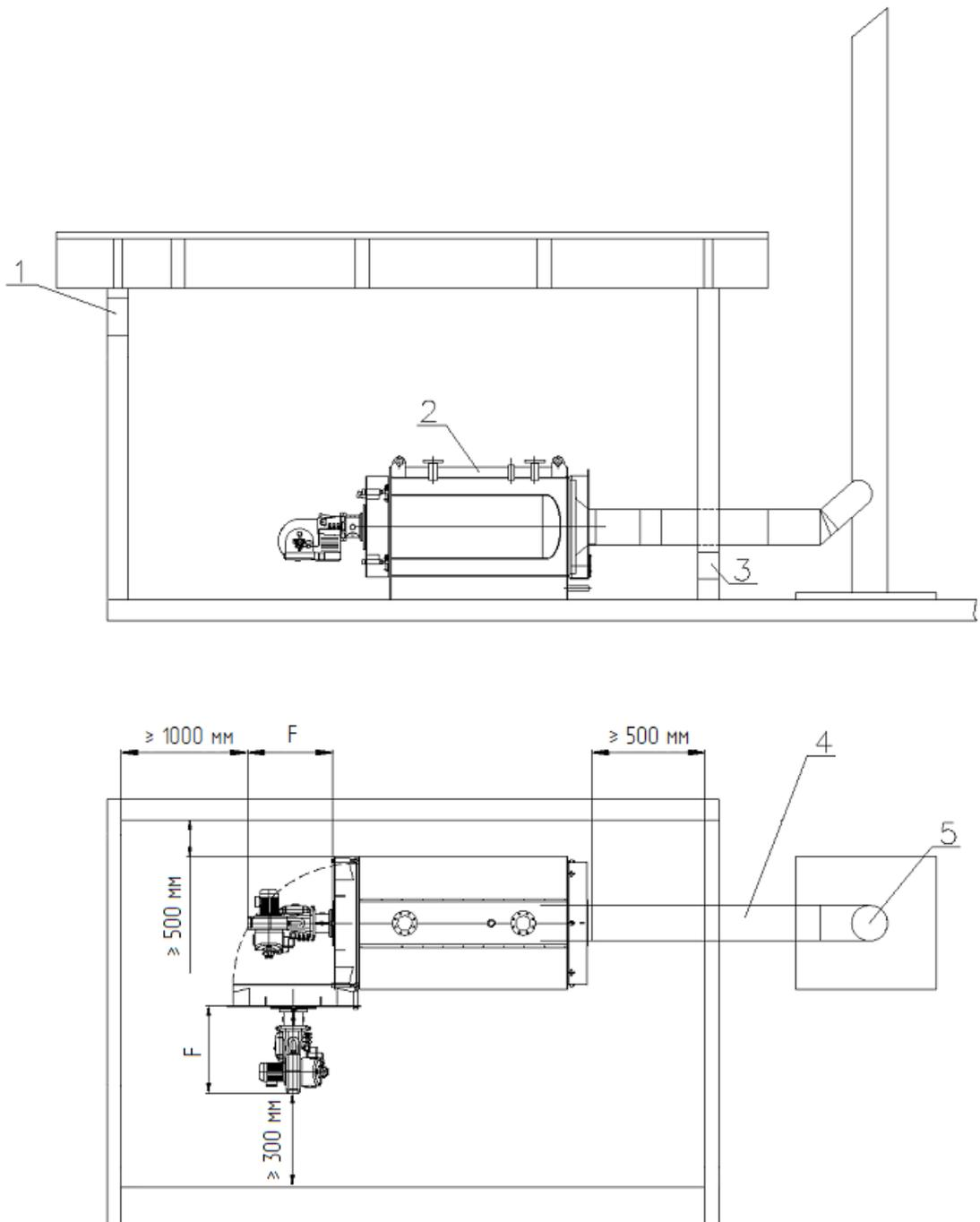
1 – вытяжной воздух; 2 – котел; 3 – приточный воздух; 4 – дымоход; 5 – дымовая труба;
