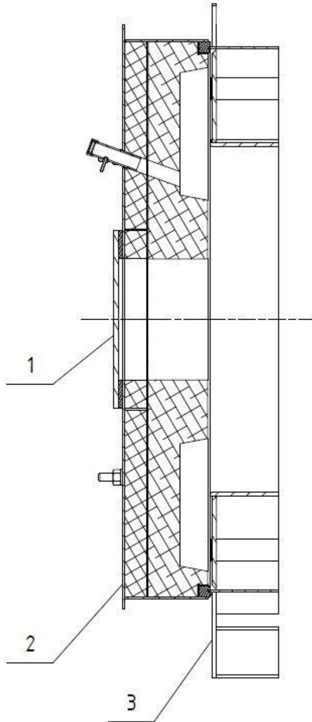
1 – переходная плита; 2 – фронтальная дверь котла; 3 – корпус котла.
