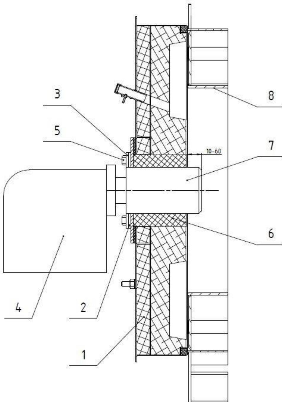
1 – фронтальная дверь котла; 2 – прокладка; 3 – фланец горелки; 4 – горелка; 5 – болты крепления горелки; 6 – уплотнение (базальтовое волокно); 7 – пламенная голова горелки; 8 – жаровая труба котла.
