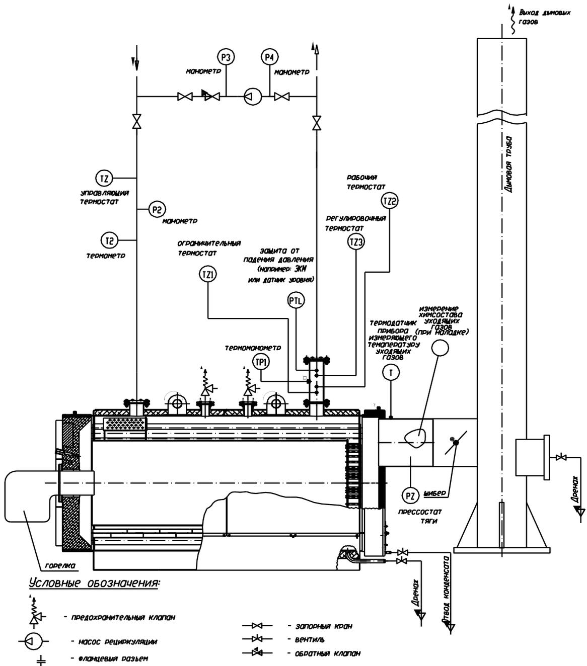
Рисунок 3 – Принципиальная (возможная) схема включения котлов
