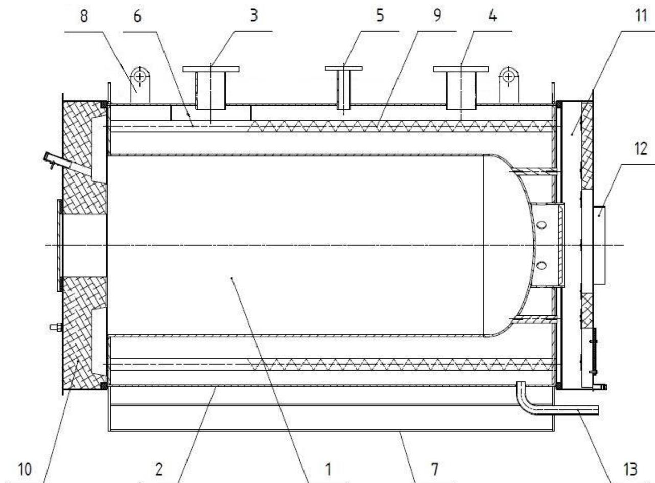
1 – жаровая труба; 2 – обечайка корпуса котла; 3 – патрубок входа воды; 4 – патрубок выхода воды; 5 – патрубок для установки предохранительного клапана; 6 – дымогарные трубы; 7 – опора котла; 8 – строповочные уши; 9 – турбулизаторы (завихрители); 10 – фронтальная дверь; 11 – задняя дверь; 12 – патрубок отвода дымовых газов; 13 – патрубок дренажа (слива).
