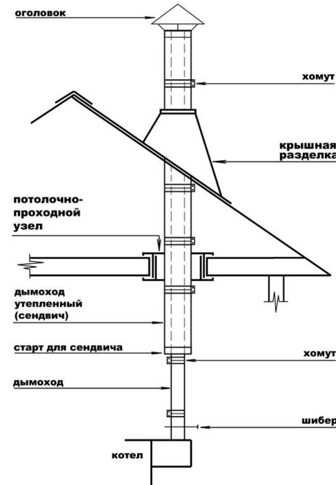
Рис. 3 — Схема дымохода
